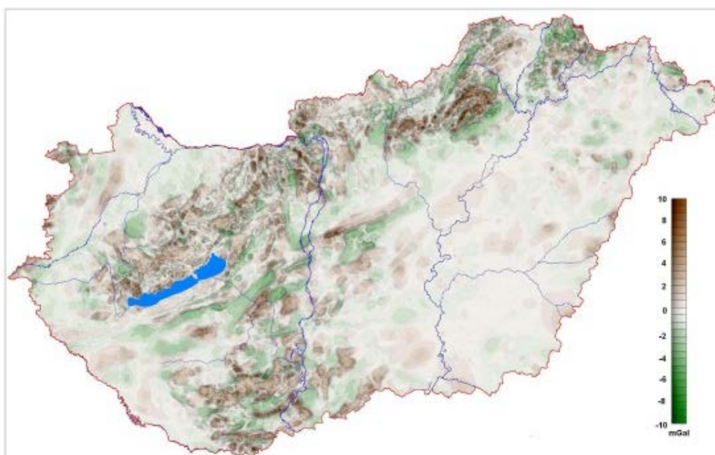
1.15. ábra: Magyarország Bouguer-anomália térképének (1.12. ábra) és az analitikus felfelé folytatás térképének (1.14. ábra) különbségként kapott maradék anomália térkép [xi]
