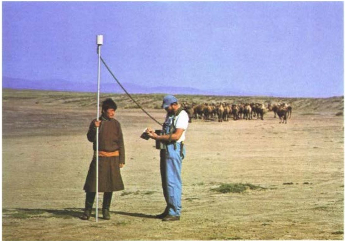
2.12. ábra: Kép egy protonprecessziós magnetométeres mérésről [3]
