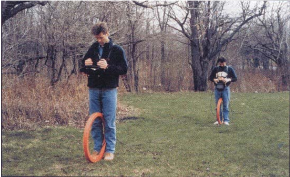
8.17. ábra: Geonics EM 34 műszer HMD elrendezésben
